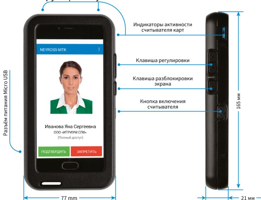
5. Не отпуская клавишу включения считывателя, поднесите идентификатор к верхней части тыльной стороны МТК. Дождитесь сигнала о завершении считывания данных карты, затем отпустите клавишу включения считывателя. Считыватель будет выключен для экономии аккумуляторной батареи.
