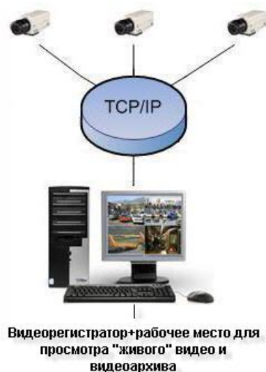
Рисунок 9 – Схема системы видеонаблюдения. Просмотр видео на компьютере видеорегистратора
