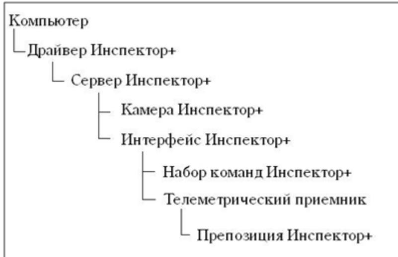
Рисунок 1 — Иерархия элементов системы безопасности
