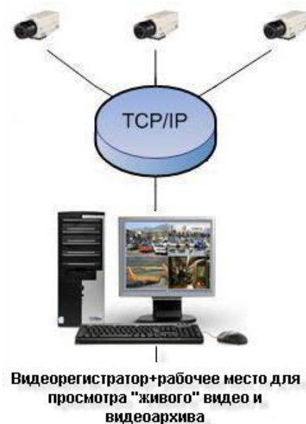
Рисунок 34 — Схема системы видеонаблюдения. Просмотр видео на компьютере видеорегистратора
