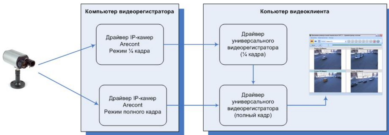
Рисунок 33 — Схема организации системы видеонаблюдения для повышения производительности видеоклиента
