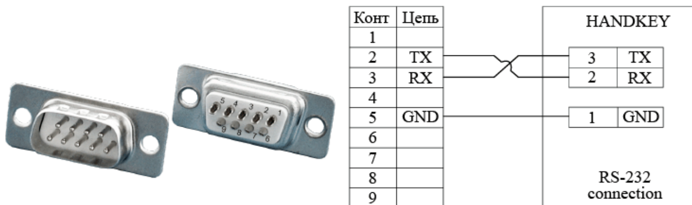
Рисунок 1 — Схема подключения Handkey-II к компьютеру посредством интерфейса RS-232
